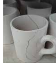
Hızlı kurutma hatası Rapid drying error
