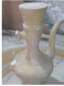
Kalıp yönüne ters açı hatası Reverse angle for mold direction
