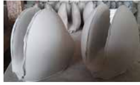
Kalıp izi hatası Mold mark error
