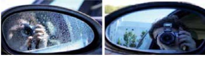
Şekil 12. Otomobil aynası, sol: kaplanmamış, sağ: TiO 2 ile kaplı [4].
