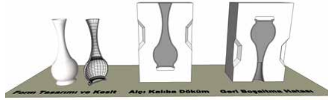
Döküm boşaltma hatası Cast pouring error
