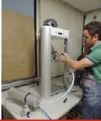
Görsel 12.13. Üç boyutlu yazıcıda bağlantı ve ayarların yapılıp, yazma işleminin başlatılması Foto: yazar Figure 12.13. Making connections and adjustments on the three-dimensional printer and accordingly initiating the printing process Photograph: Author
