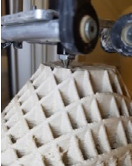
Görsel 14.15. Üç boyutlu yazıcıda baskı aşaması Foto: yazar Figure 14.15. Printing phase of three-dimensional printer Photograph: Author
