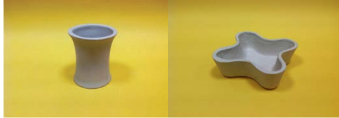
Şekil 6: Slıp döküm metoduyla şekillendirilip, 1250°C’de sinterlenen yüksek plastisiteli kil içeren vitrifiye seramikler.
