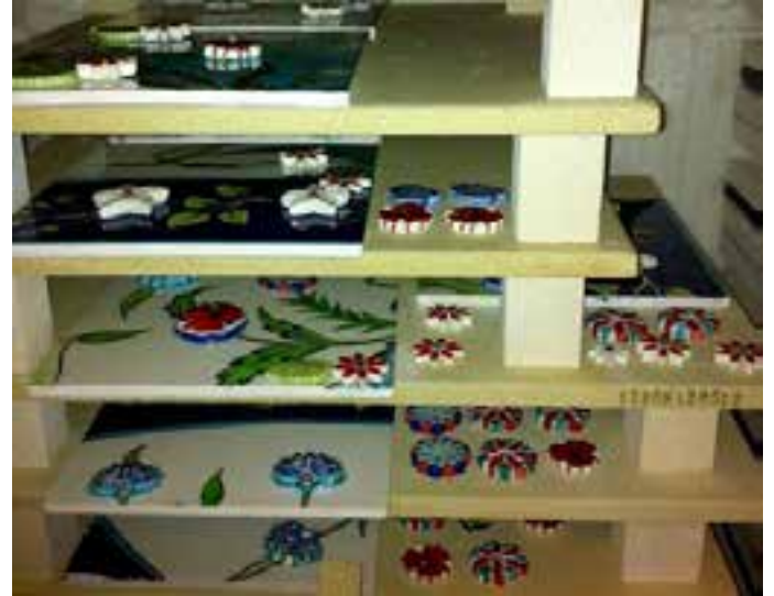
Modüler motiflerin bisküvi pişiriminden görünüm (solda); Karoların sır pişirimi sonrasında fırındaki son durumları (sağda). Shot of biscuit firing of modular motifs (left); Final state of tiles in the kiln after glazed firing (right)
