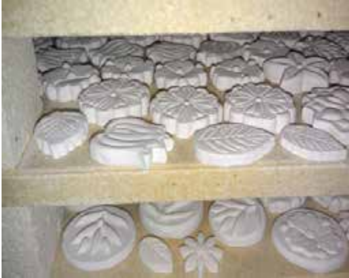
Modüler motiflerin bisküvi pişiriminden görünüm (solda); Karoların sır pişirimi sonrasında fırındaki son durumları (sağda). Shot of biscuit firing of modular motifs (left); Final state of tiles in the kiln after glazed firing (right)
