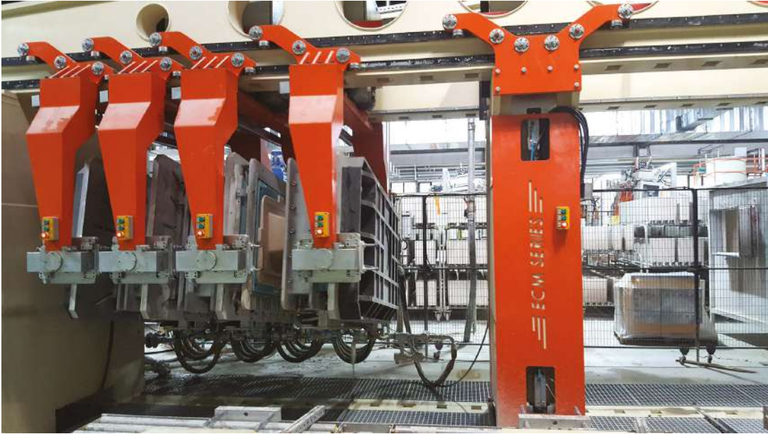
Görsel 1. Yüksek basınç lavabo döküm sistem tezgâhı. (Bien Seramik, 2020)
