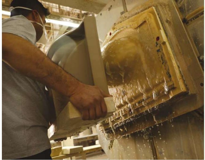
Görsel 4. Yüksek basınç kalıp yüzeylerindeki döküm çamuru suyunun gözeneklerden temizlenmesi (Genitec, 2020).
