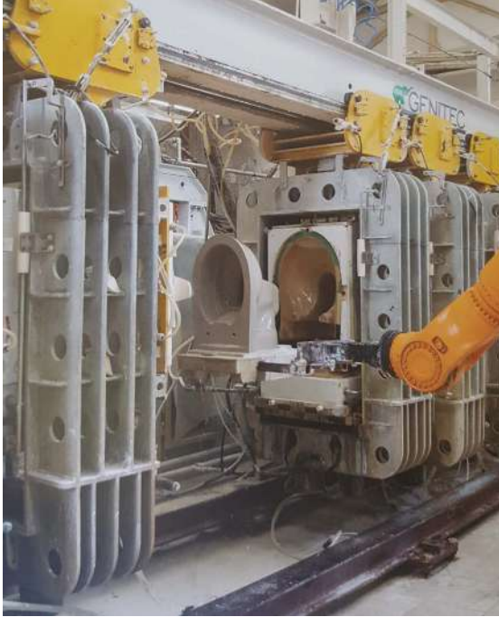
Görsel 3. Yüksek basınç kalıbından yarı yaş ürünün deforme olmadan rahat bir şekilde ürün alma ceketini üzerine alınması (Genitec 2020).
