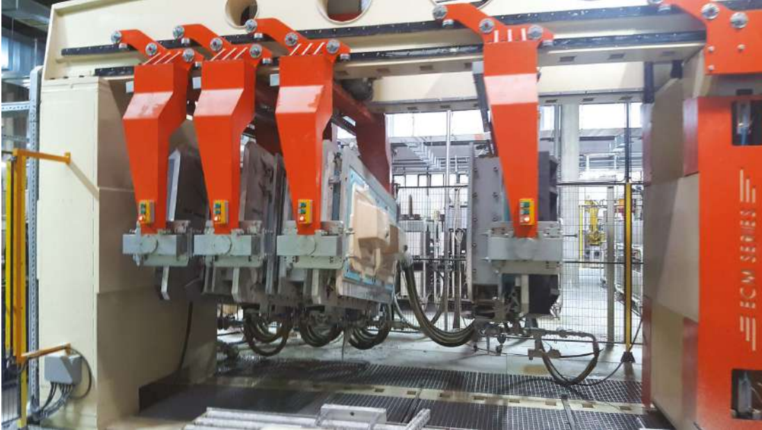
Görsel 2. Yüksek basınç döküm kalıplarının kapatılması. (Bien Seramik, 2020)
