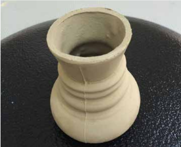
(c) Şekil 3: Ağırlıkça %20 kil içeren (a) (KÇ20) ile ağırlıkça %30 kil içeren (b) (KÇ30) Kastamonu Çamurunun Slip Döküm Formu ve 1150°C'de sinterlenen KÇ20 (c).
