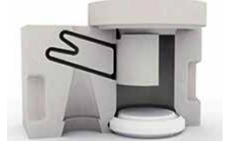
Şekil 21-22. Bilgisayar ortamında teknik resmi çizildikten sonra sanal modellemesi yapılmış fincan ve dökümü için gerekli olan tüm kalıp parçaları. Figure 21-22. Computer aided drawing and virtual modeling of all mold pieces which are necessary for the coffee cup's casting process.
