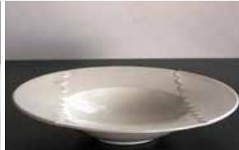
Şekil 8-9. Solda çömlekçi çarkında, sağda ise CNC de gerçekleştirilmiş alçı kalıpla, çekirdek döküm yöntemiyle üretilmiş porselen çorba tabağı. Figure 8-9. Ceramic soup plates. The one on the left is made by using potter’s wheel. The one on the right is made by using core casting method with plaster mould made on CNC tool.
