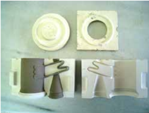
Şekil 26. Porselen döküm çamuru ile tek parça olarak dökülmüş fincan ve kalıbının diğer parçaları. Figure 27, Casting of coffee cup by porcelain clay as a sole piece and the another necessary mold pieces.
