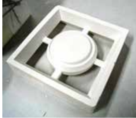
Şekil 23-25. Kalıbın en alt parçası çift taraflı olarak işlenmesi gerektiği için bir çerçeve içinde CNC tarafından oyuluyor; ortada iki tarafının da işlemi bitmiş fincanın taban kalıbı, sonunda parça kenarlarından kesilerek çerçeveden ayrılıyor. Figure 23-25 Since both sides of the lowermost part of the mould must be machined, it is craved in a frame on the CNC; machining of both sides of the middle part of coffee cup is finished; finally the part is cut from the edges and taken out of the frame
