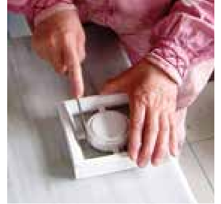
Şekil 23-25. Kalıbın en alt parçası çift taraflı olarak işlenmesi gerektiği için bir çerçeve içinde CNC tarafından oyuluyor; ortada iki tarafının da işlemi bitmiş fincanın taban kalıbı, sonunda parça kenarlarından kesilerek çerçeveden ayrılıyor. Figure 23-25 Since both sides of the lowermost part of the mould must be machined, it is craved in a frame on the CNC; machining of both sides of the middle part of coffee cup is finished; finally the part is cut from the edges and taken out of the frame
