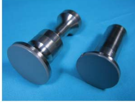
Şekil 1. \text{Si}_3\text{N}_4 seramik türboşarj rotorlar (a) ve dizel motor tapet'leri (sübab iticileri) (b) [22].
