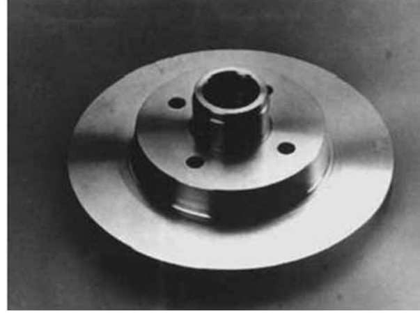
Şekil 1-b. %20 SiC partikül takviyeli A359 alüminyum alaşımından yapılmış bir araba fren diski (2) Figure 1-b. Brake disc made of A359 Al alloy reinforced with 20 vol.% of ceramic SiC particles (2)
