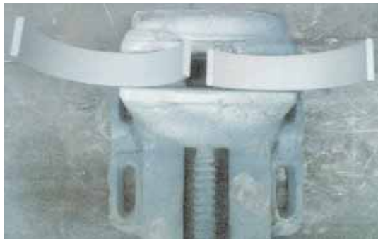
Şekil 8 c. Silindir Gömleğinden Kesilmiş Örnekler Figure 8 c. Specimens Cut out of Cylinder Sleeve
